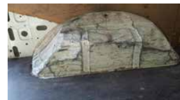
Innvendige deformeringer: Hull, kutt, deformering utenfor økonomisk berettiget reparasjon. Denaturering og feil deponering (pulver, maling osv.) (Hjulbue som ikke kan repareres hvis reparasjonstiden er < 3h)
