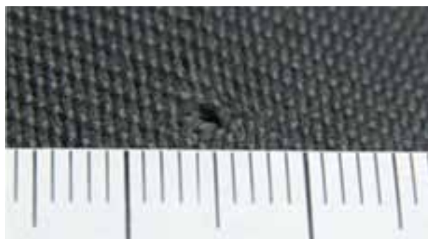
Brannskade \leq 3 mm uten hull i belegget
