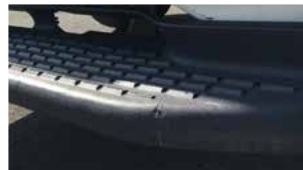
Stigbrett bak: Deformasjoner innenfor økonomisk berettiget reparasjon
