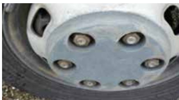
Felger og hjulskjermer: Flere oppskrapninger på overflaten med eller uten at materiale er fjernet
