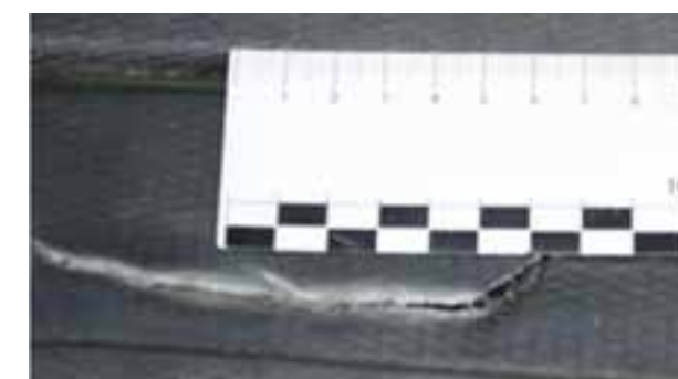
Hull på de harde plastlistene. Reparasjon av hard plastliste. I timetakst hvis det er godkjent estetsisk sett og mulig å reparere
