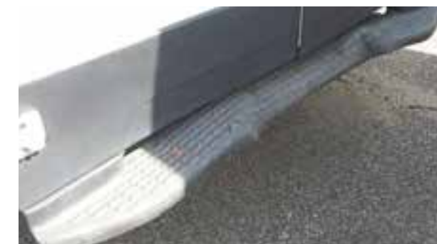
Stigbrett bak: Deformasjoner utenfor økonomisk berettiget reparasjon
