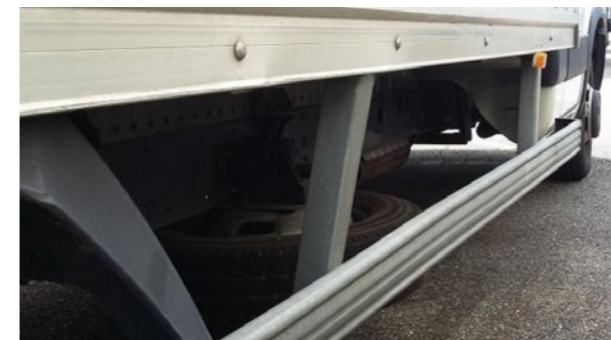
Cyklistværn: Deformation, som kan betale sig at reparere
