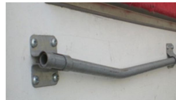
🔧 Indtræk og stænger: Stænger og indtræk deformerede, som kan betale sig at reparere
