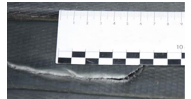
Huller i beklædningerne af hård plast. Reparation af beklædningerne af hård plast i times enhedsats hvis æstetisk acceptabelt og reparerbart
