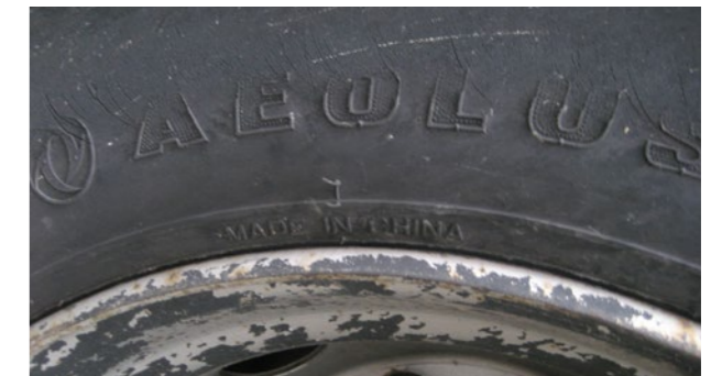
Dæk: Mønster dybde < 7 mm Bemærk: Slitagen af dækket måles i den mest slidte rille på dækket.
