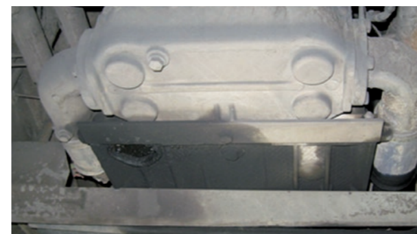
Lækager fra styretøj og servostyringspumpe
