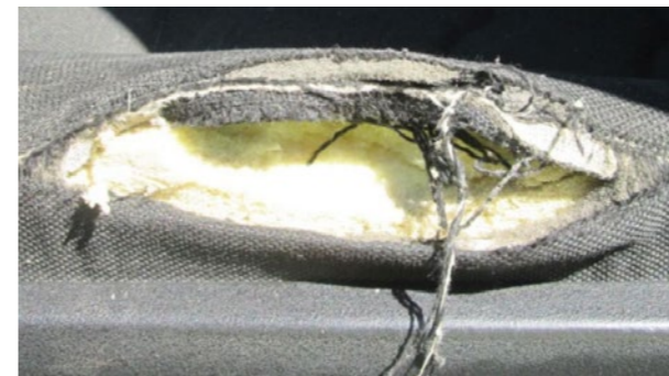
Manglende skum eller brudt plastik
