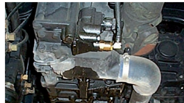
Alle lækager fra motoren, gearkassen og differentialet, hydraulisk ophæng og dæmpere
